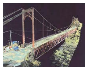
写真-2 3Dレーザースキャナによる測量結果
