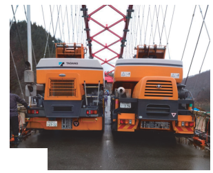
写真-4 荷重車による載荷試験の状況
