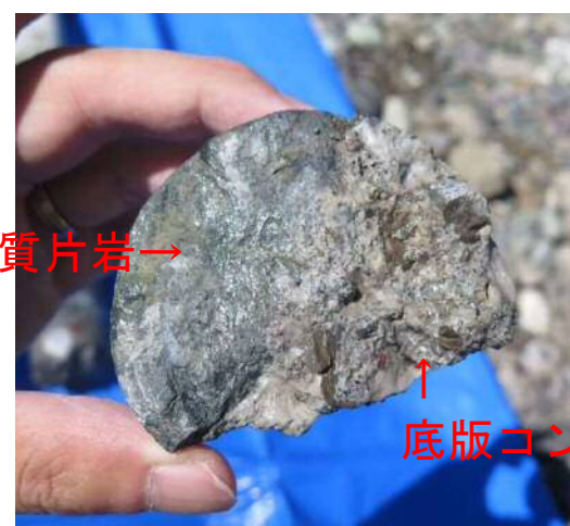
橋脚基部コアの先端に支持地盤（砂質片岩）を確認
