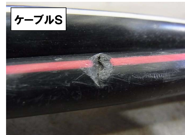
シースを貫通した傷
