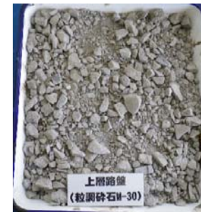
粒調碎石M-30 (最大粒径30mmの碎石)
