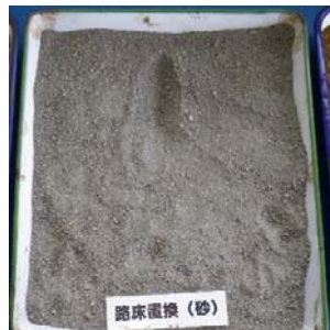
▲設計CBR=3%のときの N_4 交通(1日の大型車交通量が250台未満)相当の厚さ
