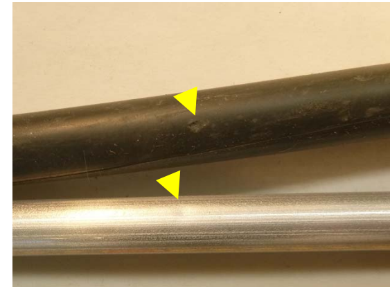
【損傷】外部導体(内部構造)の変形
