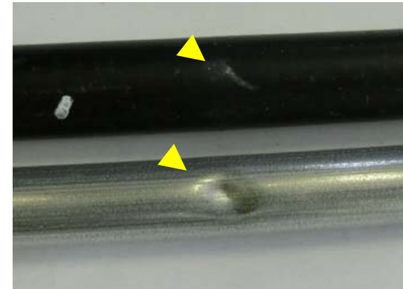
【損傷】外部導体(内部構造)の変形
