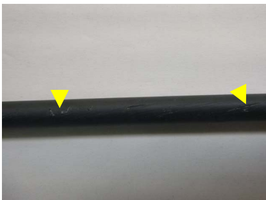
【検証外】 支障無い程度の小傷有り
