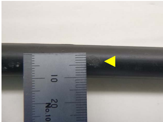
【損傷】傷の大きさ（長さ）5mm
