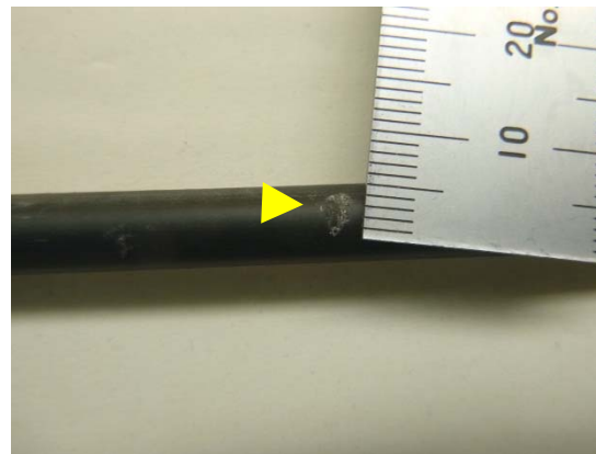
【損傷】 傷の大きさ（長さ）4 mm
