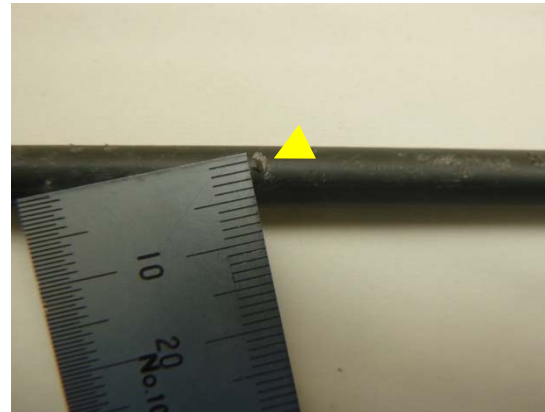
【損傷】 傷の大きさ（長さ）3 mm
