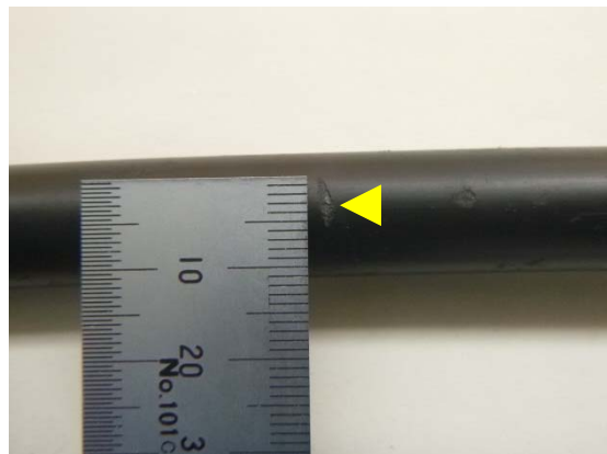
【損傷】 傷の大きさ（長さ）6mm
