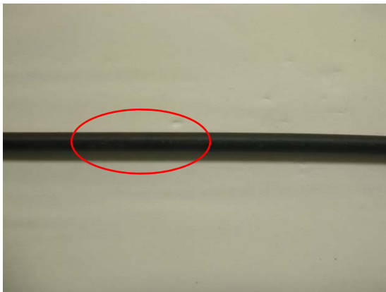
【検証外】支障無い程度の小傷有り
