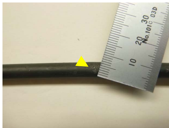
【損傷】傷の大きさ（長さ）5mm
