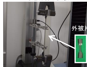
引張り伸び試験
