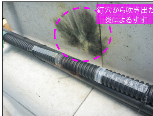
実験後の状態(電力ケーブル)
