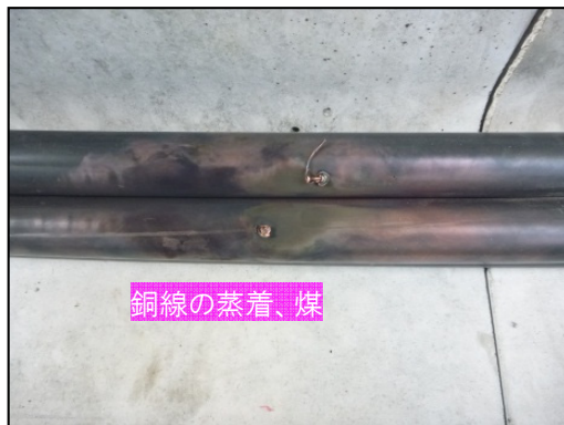
実験後の状態(電力ケーブル)
