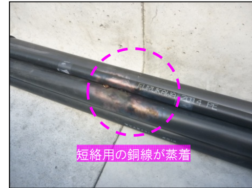
実験後の状態(通信ケーブル・10cm)
