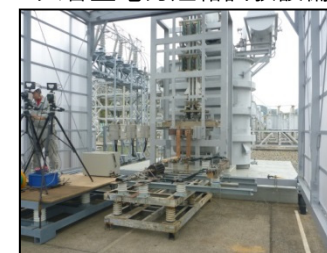
大容量電力短絡試験設備
